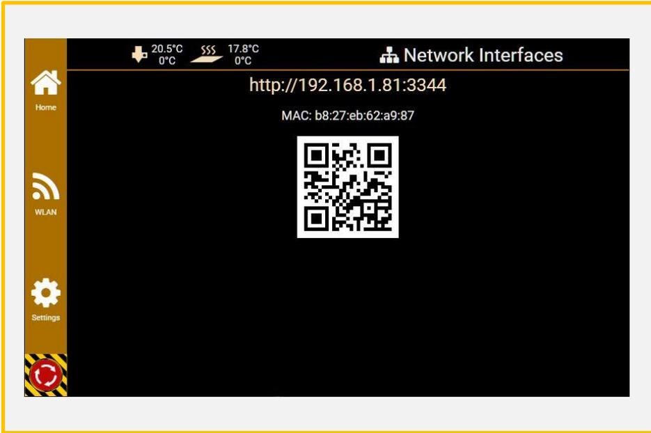
1. Settings -> Network를 누른 후 화면에 표시 된 IP 주소를 기억하여 인터넷 주소창에 입력 후 접속합니다.
