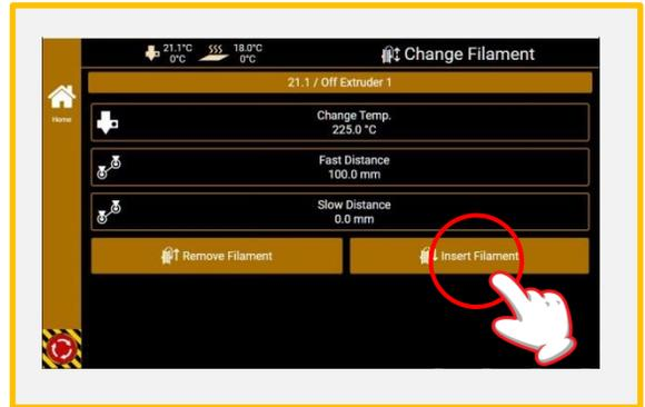
2. 아래와 같이 설정값을 변경 한 후에 화면의 Remove Filament를 클릭합니다.
